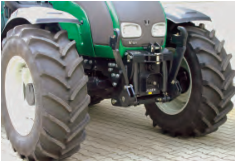
Anlenkpunkt vom Unterlenkerträger sehr nahe an der Vorderachse: Hohe Bodenfreiheit.
