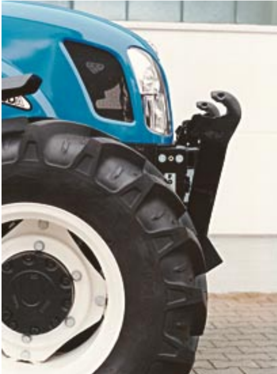
Ausführung TND-A/I Vollintegrierter Anbau. Unterlenker hochgeklappt serienmäßig mit Walterscheid Schnellkuppler
