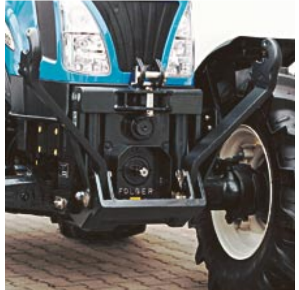
Ausführung TND-A/I Anlenkpunkt vom Unterlenkerträger sehr nahe an der Vorderachse. Hohe Bodenfreiheit.
