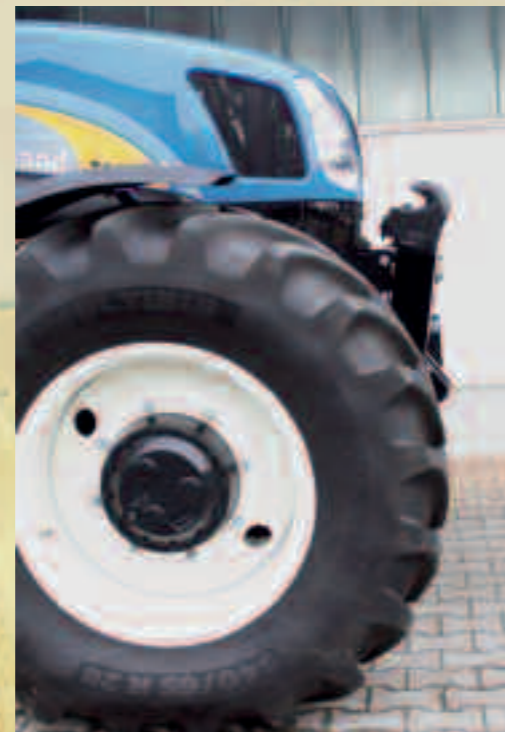
Absolut traktornaher Anbau, Unterlenker hochklappbar, serienmäßig mit Walterscheid-Schnellkuppler
