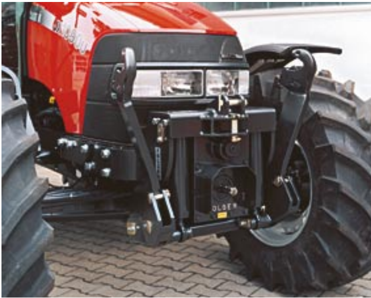
Anlenkpunkt vom Unterlenkerträger sehr nahe an der Vorderachse. Hohe Bodenfreiheit.
