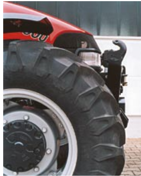
Absolut traktornaher Anbau, Unterlenker hochklappbar, serienmäßig mit Walterscheid-Schnellkuppler.
