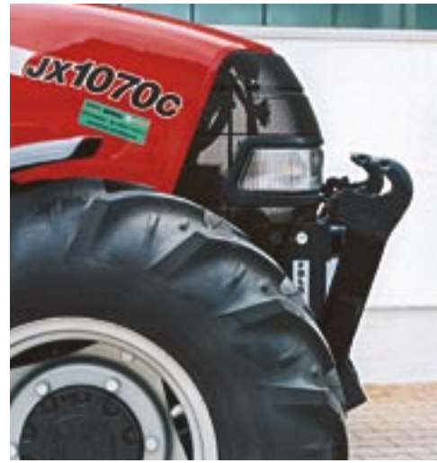
Ausführung JXC/I Absolut traktornaher Anbau, Unterlenker hochklappbar, serienmäßig mit Walterscheid-Schnellkuppler.
