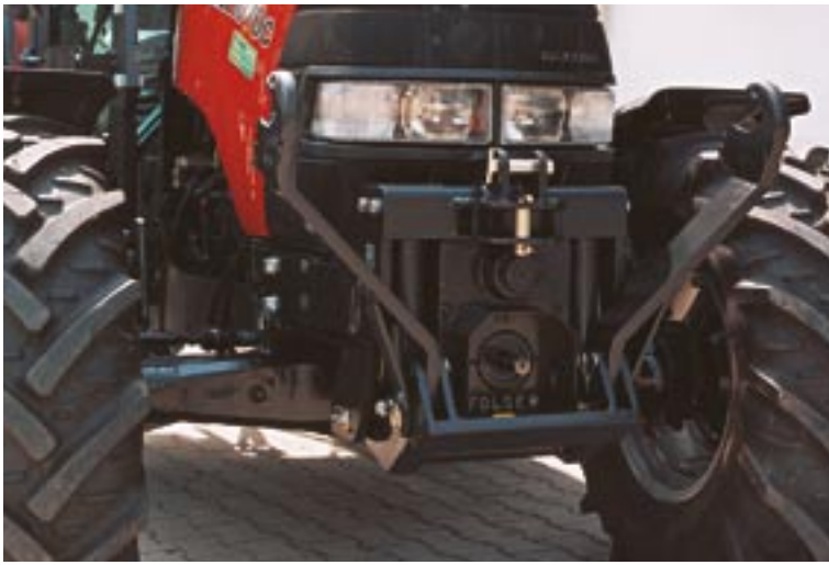
Ausführung JXC/A Anlenkpunkt vom Unterlenkerträger sehr nahe an der Vorderachse. Hohe Bodenfreiheit.
